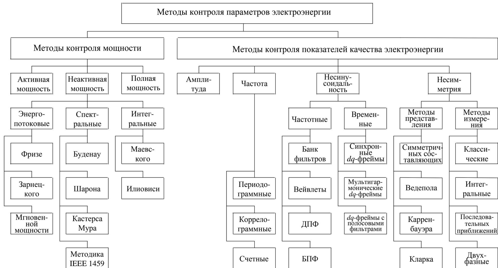
Рис. 1. Классификация методов контроля параметров электроэнергии
